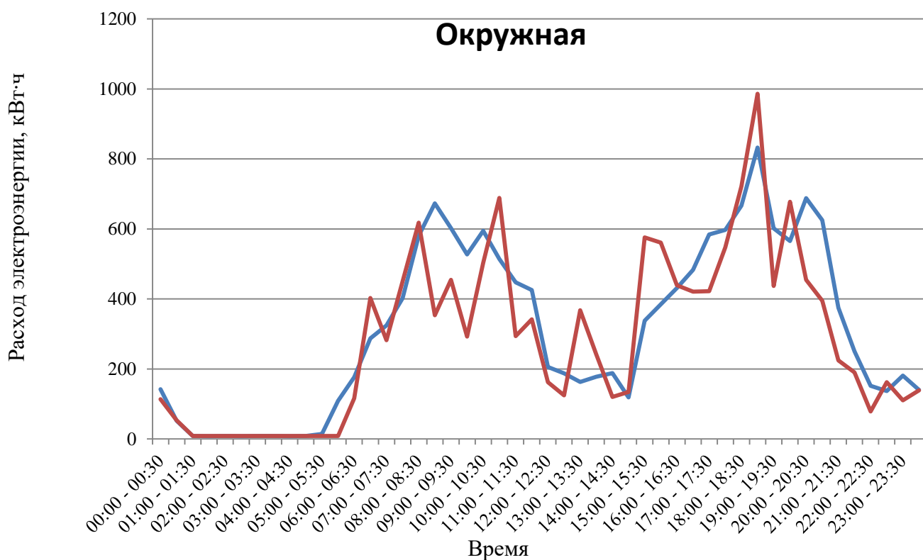
Рисунок 3.5 – Результаты сравнения расхода электроэнергии по данным Системы и АСКУЭ для тяговой подстанции Окружная за 10.04.2019 г.
