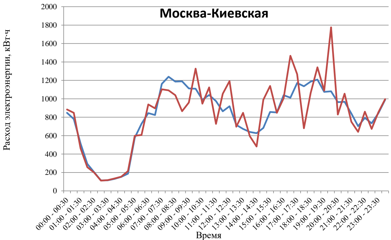
Рисунок 3.4 – Результаты сравнения расхода электроэнергии по данным Системы и АСКУЭ для тяговой подстанции Москва-Киевская за 10.04.2019 г.
