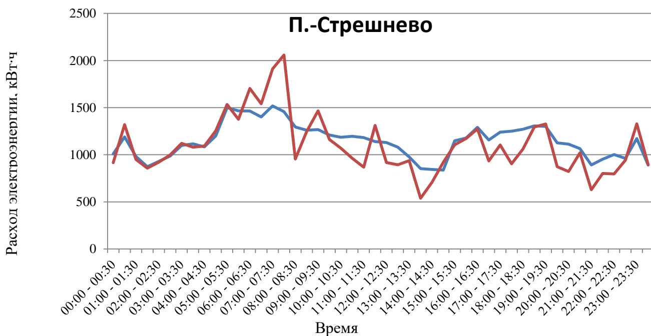
Рисунок 3.6 – Результаты сравнения расхода электроэнергии по данным Системы и АСКУЭ для тяговой подстанции Покровское-Стрешнево за 10.04.2019 г.
