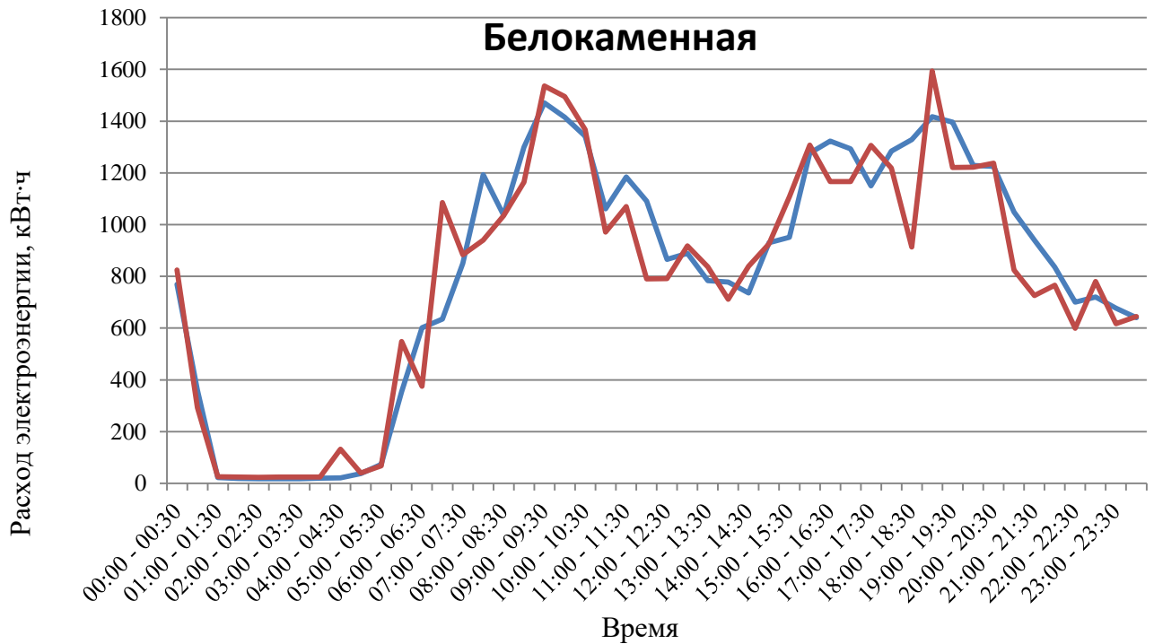
Рисунок 3.3 – Результаты сравнения расхода электроэнергии по данным Системы и АСКУЭ для тяговой подстанции Белокаменная за 10.04.2019 г.
