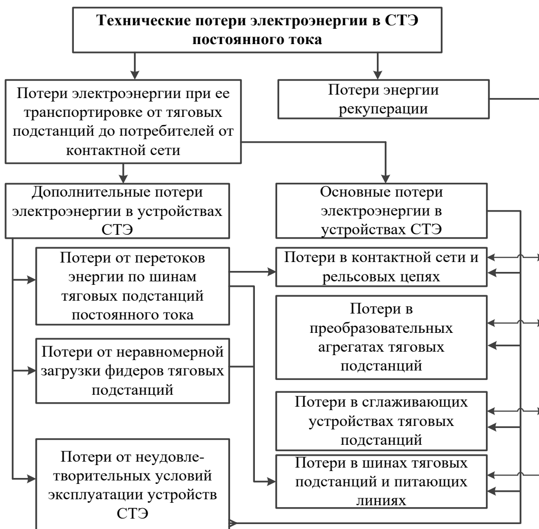
Рисунок 2.1 – Структура технических потерь электроэнергии в СТЭ постоянного тока
