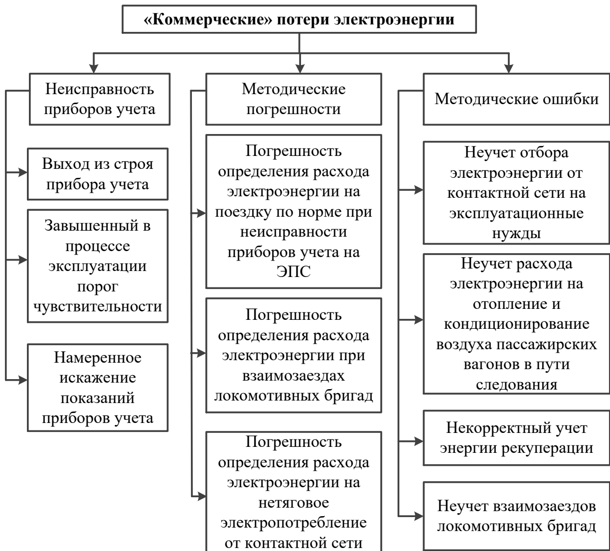
Рисунок 2.2 – Структура «коммерческих» потерь электроэнергии на тягу поездов
